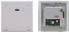
WP-580T ist ein Hochleistungs-Übertrager für 4K @60 Hz (4:2:0) HDMI-Signale mit RS-232 und IR per HDBaseT über Twisted Pair als aktives Wandanschlussfeld. Er hat einen Eingang für HDMI-Signale und wandelt diese in ein HDBaseT Twisted Pair Signal für die Übertragung an den Empfänger WP-580R. Auch als WP-580T(D) für DECORA®-Rahmen erhältlich
