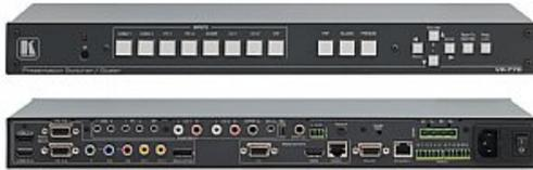
VP - 770 ist ein Hochleistungs-Präsentationsumschalter und -Scaler für Comp.Video, Komponentenvideo, DisplayPort, Computergrafik und HDMI. Er skaliert Video, koppelt Audio ein und gibt das Signal zusammen mit Digitalaudio, unsymmetrischem Stereo-Audio sowie als 2x 10 W Lautsprecher-Ausgang als HDMI, Computergrafik und DGKat Twisted Pair aus
