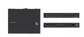
VP-427H2 ist ein Hochleistungs-Empfänger/Scaler für HDBaseT-Twisted-Pair-, HDMI-, bidirektionale RS-232- und IR-Signale mit erweiterter Reichweite. Das Gerät empfängt ein HDBaseT-Signal, das in HDMI konvertiert wird und lässt Ethernet-, IR- und RS-232-Signale sowie ein unsymmetrisches Stereo-Audiosignal durch. Es skaliert das Bild nach oben oder unten, um es an die Auflösung des HDMI-Monitors anzupassen
