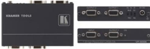
VP-300K ist ein Hochleistungs-Verteilverstärker für Computergrafik-Videosignale mit Auflösungen bis UXGA und höher. Er hat einen Eingang, nach Pufferung und Entkopplung verteilt er das Signal an drei identische Ausgänge
