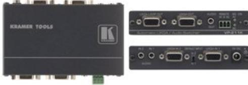
VP-211K ist ein Hochleistungs-Umschalter für Computergrafik-Video Signale mit Auflösungen bis UXGA oder höher und unsymmetrisches Stereo-Audio. Wenn der VP-211K als Standby-Umschalter konfiguriert ist, schaltet er automatisch auf den Sekundär-Eingang, wenn das Signal am Primär-Eingang ausfällt
