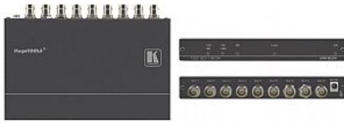
VM-8UX ist ein kompakter und leistungsstarker 1:8-4K-Verteiler für SDI-Standard-SDI-Signale mit einer Übertragungsrate bis 12G. Er passt sich automatisch an die Datenrate eines SDI-Eingangssignals an, entzerrt und taktet das Signal neu, um die Reichweite des übertragenen Signals zu verbessern, und verteilt das Signal an acht identische SDI-Ausgänge
