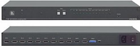
VM-8HN ist ein UHD (4K) Verteilverstärker 1:8 plus 2x Durchschleifung für HDMI-Signale. Er führt Neutaktung und Entzerrung des Signals durch und verteilt es an acht identische Ausgänge und zwei Durchschleif-Ausgänge mit maximaler Auflösung 4K @60 Hz (4:2:0). Ein weiteres Gerät kann in Reihe als Daisy Chain angeschlossen werden
