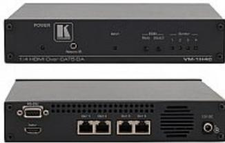
VM-1H4C ist ein hochqualitativer TP-Verteilverstärker für HDMI-Signale mit PoC (Power over Cable). Das Gerät empfängt serielle Befehle und IR-Signale transparent über den RS-232 Port und den TP-Link. Das Eingangssignal wird neugetaktet, entzerrt und dann an vier DGKat TP-Ausgänge verteilt
