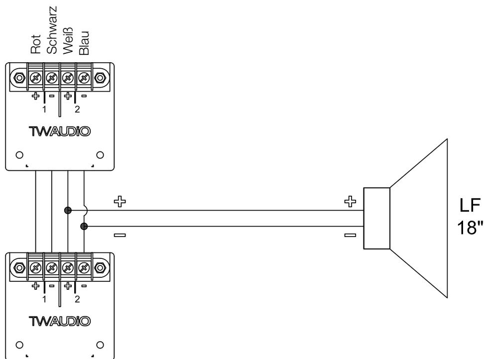
Abbildung 3.2 - Anschlussdiagramm
