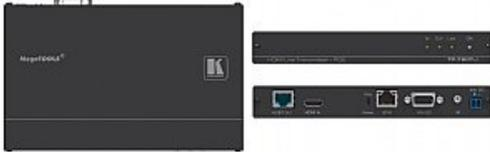
TP-780Txr ist ein Hochleistungs-TP-Übertrager (HDBaseT) für 4K @60 Hz (4:2:0) UHD, 2Kx4K HDMI, Ethernet, bidirektionales RS-232, IR-Signale und PoE. Das Gerät hat Eingänge für HDMI, Ethernet, RS-232 und IR und wandelt diese Signale in ein HDBaseT TP-Signal und überträgt dies über CAT-Kupferkabel an den Empfänger, der das Signal zurückwandelt in die Ausgangsformate. Dabei ist die Übertragungreichweite 100 m, bei geringerer Auflösung auch darüber hinaus
