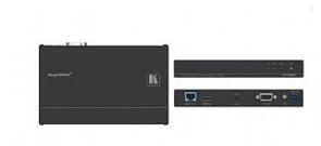
TP-780T ist ein Twisted Pair Übertrager für HDMI, bidirektionales RS-232 und IR. Er unterstützt Auflösungen bis 4K @60 Hz (4:2:0) UHD. Das Gerät wandelt HDMI, RS-232 und IR-Signale in ein TP-Signal und überträgt dies per HDBaseT an einen Empfänger, der das TP-Signal wieder zurück in 4K HDMI, bidirektionales RS-232 und IR wandelt. Für 4K @60 Hz (4:2:0) ist die Übertragungsreichweite 40 m über Kupferkabel, bei geringerer Auflösung auch darüber hinaus. Der TP-780T unterstützt PoE
