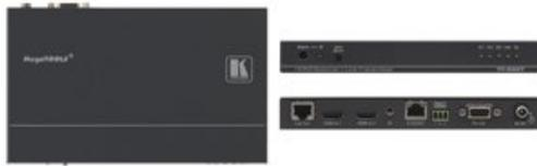
TP-582T ist ein hochwertiger Twisted Pair HDBaseT Übertrager für HDMI-, Ethernet-, bidirektionale RS-232 und IR-Signale. Er wählt einen von zwei HDMI-Eingängen aus und wandelt dieses Signal zusammen mit den Ethernet-, RS-232- und IR-Eingangssignalen in ein Twisted Pair Signal. Der TP-582R wandelt das empfangene Twisted Pair Signal zurück in die Ausgänge für Ethernet, RS-232, IR und 2x HDMI. Außerdem koppelt er Audio aus und gibt es digital als S/PDIF und TOSLINK® aus
