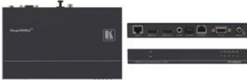
TP-582R ist ein hochwertiger HDBaseT Twisted Pair Empfänger für HDMI-, Ethernet-, bidirektionale RS-232 und IR-Signale. Der TP-582R wandelt das empfangene Twisted Pair Signal zurück in ein Ethernet 100BaseT, RS-232, IR und zwei HDMI-Ausgangssignale. Außerdem koppelt er Audio aus und gibt es digital als S/PDIF und TOSLINK® aus. Das Videosignal mit max. 1080p @60 Hz, 36 bpp wird dabei bis 130 m über CAT-Kupferkabel übertragen
