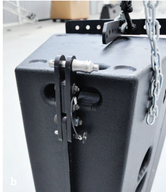
Arretieren Sie das Oberteil des BBT24 im oberen Griff der T24, indem Sie den Kugelsperbolzen wieder befestigen.
