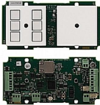
RC-76M ist eine Raumsteuerung für Multimedia-Räume mit 6 konfigurierbaren Tasten zum Einbau in Standard Merten System M Wanddosen. Gesteuert werden als separates Einzelgerät oder über Ethernet mit Site-CTRL™ Software oder über KNET™ Audiokomponenten, Videokomponenten und andere Raumeinrichtungen wie Licht und Bildwände in komplexen Systemen.
