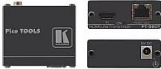
PT-580T ist ein kompakter HDBaseT Twisted Pair Übertrager für HDMI-Signale bis 4K 60 Hz (4:2:0). Das Gerät erhält das HDMI-Signal und wandelt dies in ein Twisted Pair Signal. Ein HDBaseT-Empfänger wie z.B. der TP-580R oder WP-580R wandelt das Twisted Pair Signal zurück in das originale 4K UHD HDMI-Signal. Die Reichweite ist 40 m mit 4K @60 Hz (4:2:0) 24 bpp über CAT-Kupferkabel und länger mit Signalen geringerer Auflösung
