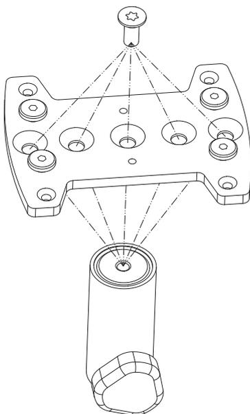
1. Ermitteln Sie mit Hilfe der Simulationssoftware EASE Focus den Befestigungspunkt des Hochständeradapters. Fünf Löcher für die Senkkopfschraube stehen dafür zur Auswahl (siehe gestrichelte Linien).
