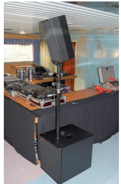
Bild 24: M-8 und B-15 beim Praxistest – man beachte die akustisch nicht unproblematische, sehr niedrige Deckenhöhe auf dem Schiff
