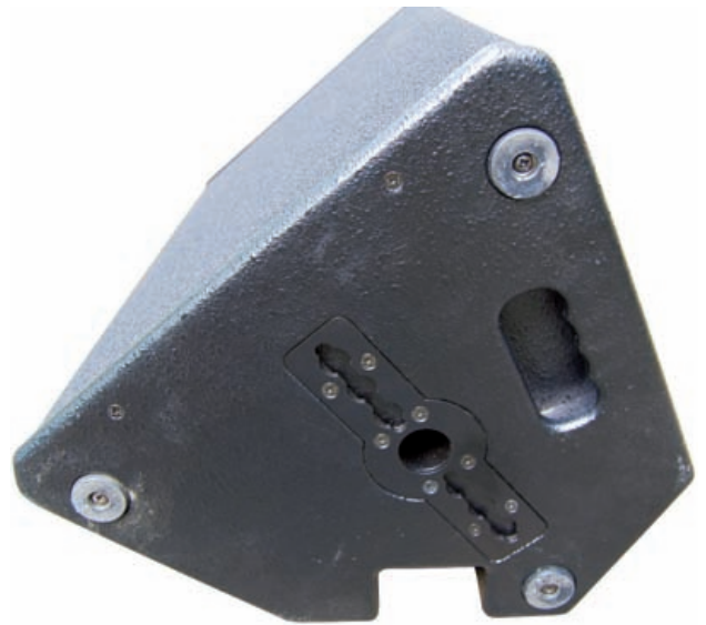
Abb. 2: Unterseite der M-15 mit Schwenkbügelaufnahme bzw. Flugpunkten sowie 36-mm-Stativflansch, rechts darüber eine der beiden Griffschalen
