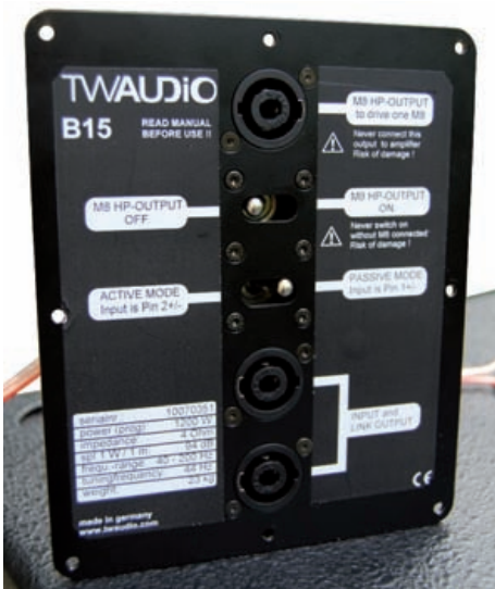
Abb. 6: Anschlusspanel und Umschalteneinheit des B-15
