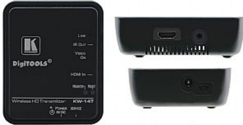
KW-14T und KW-14R bilden eine drahtlose High-Definition HDMI Sender- und Empfänger-Kombination zur latenzfreien Übertragung hochauflösender HDMI-Signale im Innenbereich. Bis zu vier KW-14R Empfänger können Signale eines KW-14T Senders empfangen und bis zu drei KW-14T Sender können mit einem einzelnen KW-14R Empfänger gepaart werden. KW-14T und KW-14R werden als Set ausgeliefert
