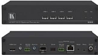
692 ist ein leistungsfähiger HDBaseT 2.0 LWL-Empfänger für Ultra-Reichweite von 4K 60 Hz (4:2:0) HDMI, USB, Ethernet, RS232, IR und Stereo-Audiosignalen über Multimode oder Singlemode Faseroptik. Das Gerät wandelt das vom Übertrager z.B. 691 erhaltene HDBaseT 2.0 Signal zurück in 4K60 (4:2:0) HDMI, USB 2.0, Ethernet, RS-232, IR und Stereo-Audio. Der 692 empfängt das Signal nach LWL-Übertragung im Multimode über 3 km und im Singlemode über 33 km
