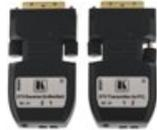
602T und 602R sind kleine steckbare Übertrager und Empfänger für DVI-Signale über LWL. Der 602T wandelt ein DVI-Signal in ein LWL-Signal, der 602R wandelt das eingehende LWL-Signal zurück in das originale DVI-Signal
