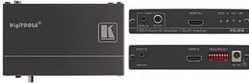
FC-69 ist ein Hochleistungs HDMI Audio Ein- und Auskoppler für 4K @60 UHD (4:2:0) und 4Kx2K. Das Gerät koppelt Analogaudio in den HDMI-Ausgang ein oder koppelt Audio aus dem HDMI-Eingang oder aus dem Audio-Rückkanal aus mit gleichzeitiger Wandlung in S/PDIF und unsymmetrisches Stereo-Audio am Ausgang
