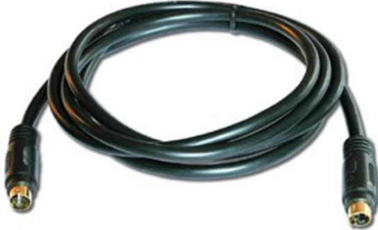
Die Kabel der Kramer SM/SM Serie sind Hochleistungs- S-Video (Y/C) Kabel mit vergossenen 4-poligen Hosidensteckern an beiden Enden. Sie übertragen die Luminanz- und Chrominanz-Signale auf separaten Leitungen für eine höhere Qualität im Vergleich mit Composite-Video Signalen
