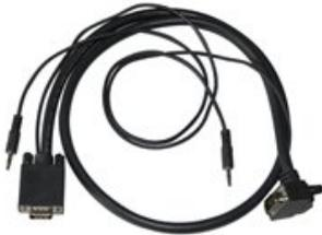
C-GMA/GMA(90) sind hochqualitative VGA + Stereo-Audio Anschlusskabel mit einem abgewinkelten Stecker für Computergrafiksignale. Das Kabel hat einen HD15-Stecker sowie einen 3,5 mm Klinenstecker für Audiosignale. Ein Ende des Kabels ist mit einem 90 Grad nach unten abgewinkelten HD15-Stecker versehen, zur einfachen Installation in Bodentanks oder zur platzsparenden Installation hinter Wandanschlussfeldern
