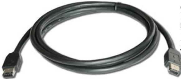
C-FM6/FM6 ist ein Hochleistungskabel mit 6-Pin FireWire-Stecker an beiden Enden. Es wird hauptsächlich eingesetzt zum Datentransfer (IEEE 1394) mit Geschwindigkeiten bis 400 MBit/s zwischen Multimedia-Geräten wie Digitalkameras, Videorekordern, CD-Laufwerken, Festplatten-Laufwerken, Scannern, Grafikkarten und Editier-Systemen
