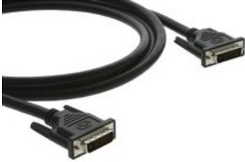
C-DM/DM ist ein Hochleistungs-Kabel mit vergossenen DVI-D Steckverbindern an beiden Enden. Diese Dual-Link Kabel wurden entworfen zur Übertragung von ausschließlich digitalen Signalen (24+1 polig) und werden verwendet zur direkten digitalen Verbindung zwischen Signalquellen und Anzeigegeräten wie Flachbildmonitoren und Daten-/Video-Projektoren
