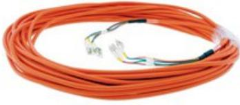
C-4LC/4LC ist ein Glasfaserkabel mit vier einzelnen farbkodierten Multimode 50/125  $\mu\text{m}$  Simplexkabeln mit jeweils 2,0 mm Durchmesser mit einem gemeinsamen runden orangefarbenen Außenmantel. Sie werden vorzugsweise mit verschiedenen Kramer Übertragern und Empfängern, die mit steckbaren Kabeln arbeiten, eingesetzt
