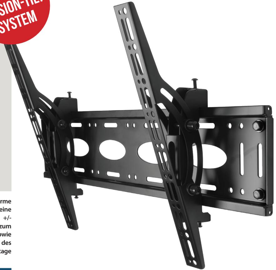
Die BT8432 ist eine Wandhalterung für Flachbildschirme mit einem einzigartigen Torsion-Tilt-Mechanismus, der eine einfache Neigungsverstellung des Bildschirms von bis zu +/-15° ermöglicht. Die BT8432 enthält Nivellierschrauben zum Einstellen der Bildschirmenebene nach der Installation sowie Sicherungsschrauben, die ein unbefugtes Entfernen des Bildschirms verhindern. Sie eignet sich auch für die Rohrmontage mit den B-Tech-Schellen.
