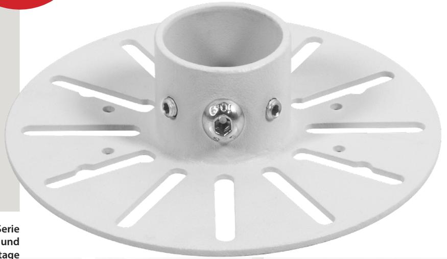
Die BT5910 ist Teil der System V-Reihe von B-Tech, einer Serie von Komponenten für die Deckenmontage von CCTV- und anderen Geräten. Diese CCTV-Halterung ist für die Montage einer kleinen bis mittelgroßen Dome-Überwachungskamera mit einem Gewicht von bis zu 5 kg an BT5935 Ø38mm-Rohren ausgelegt. In Kombination mit anderen System V-Komponenten kann eine professionelle Überwachungskameralösung erstellt werden, die spezifischen Anforderungen gerecht wird.
