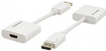
Mit dem ADC-DPM/HF/UHD von Kramer können Sie Ihren mit DisplayPort™ ausgestatteten PC oder Laptop an ein HDMI™-Display anschließen. Dieser aktive DisplayPort-auf-HDMI-Adapter wird für echte Konvertierung verwendet, wenn die Quelle DP++ nicht unterstützt und kann entweder in DisplayPort-Singlemode- oder Dual-Mode-Ausgaben verwendet werden. ADC-DPM/HF/UHD unterstützt bis 4K @60 Hz (4:4:4) Videoauflösung und HDCP 2.2
