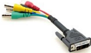
ADC-DMA/5BF-1 ist ein 30 cm langes Adapterkabel zwischen dem analogen Teil des DVI-I Steckers und typischem RGBHV. DVI-Videokarten geben oft das Ausgangssignal sowohl digital als auch analog aus, und umgekehrt akzeptieren Displays oft das analoge VGA-Signal über eine DVI-Buchse
